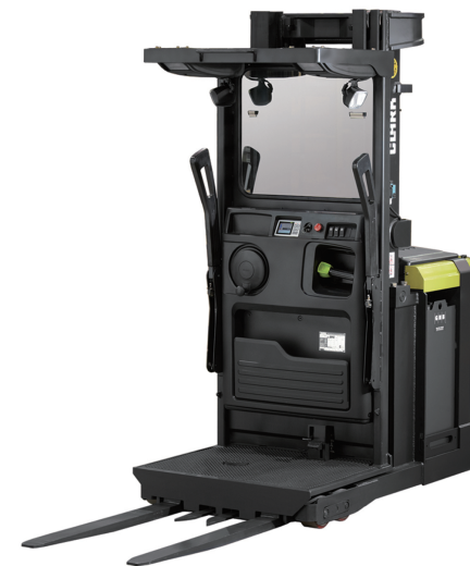
Empilhadeira com carrinho com toma de pedidos movida a bateria
