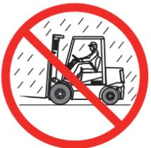
Se a empilhadeira for operada em ambiente externo durante a chuva, certifique-se de que a proteção teto da cabine do condutor esteja no lugar para evitar a exposição a chuva e danos aos componentes elétricos
