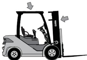
O protetor de sobrecarga não deve ser alterado conforme a especificação CLARK.
